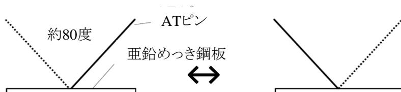
図1 溶接折り曲げ試験の様子
